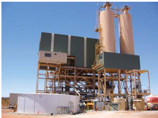
Рис. 4. Установка для смешивания отходов обогащения и добавок
