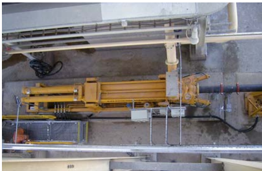
Рис. 7. Шламовый насос серии HSP, работающий в составе комплекса приготовления и подачи закладочной смеси
