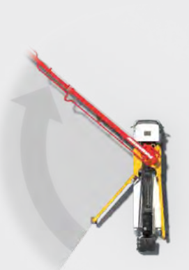
Установка опор Ls/Rs (левое узкое / правое узкое)
