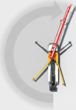
Установка опор типа LF/RF (слева спереди / справа спереди)
