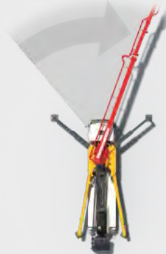
Установка опор F (спереди)
