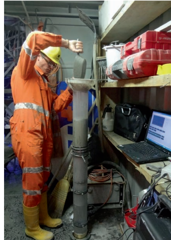
▲ Sliper Test zur Ermittlung der Pumpfähigkeit des Betons
