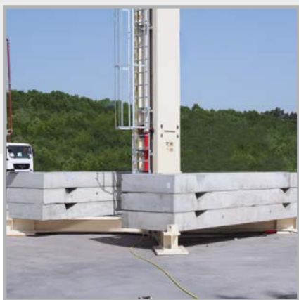
Опорная крестовина, нагруженная балластом (1)
