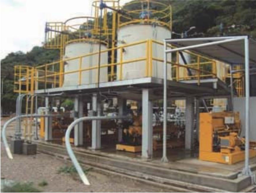
Участок с двумя насосами фирмы Putzmeister (Путцмайстер) для перекачки нефти с песком
